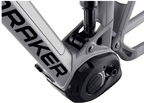
CARCASA DEL MOTOR INTEGRADA
